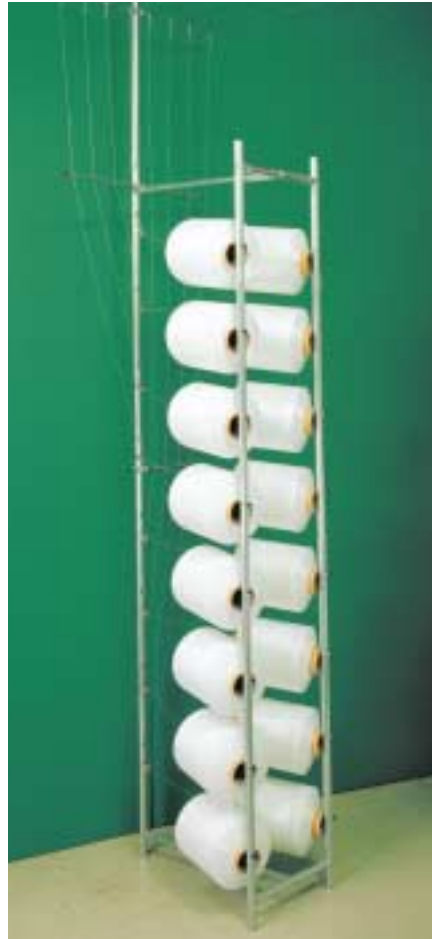
VARI Seitengatter kann auch ohne Röhrchen eingesetzt werden. VARI side creel can also be used without tubes.
