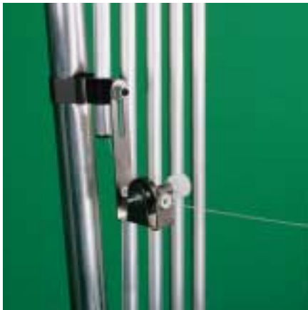
Tellerbremse für VARI mit Reservespule (Standard bei Halbrundgatter). Disc brake for VARI with reserve cones (standard for semi-circular creel).
