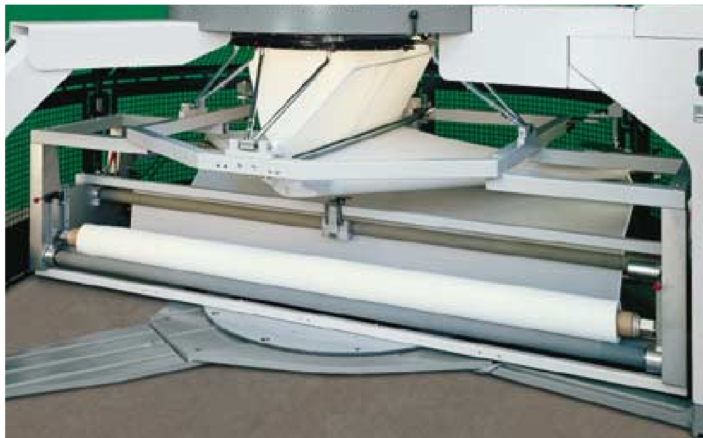
Estiraje homogéneo – enrollado homogéneo a través del ancho de todo el género.
