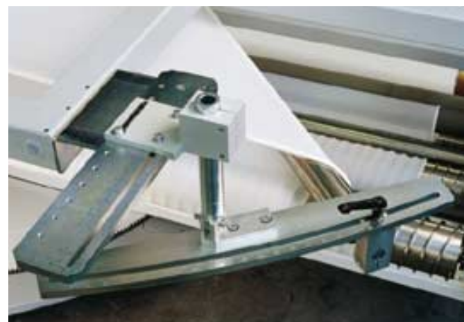
Gracias al sencillo ajuste tridimensional al ancho correspondiente del género, no se producen deformaciones del mismo. Los valores son reproducibles mediante un proceso de escalonamiento.
