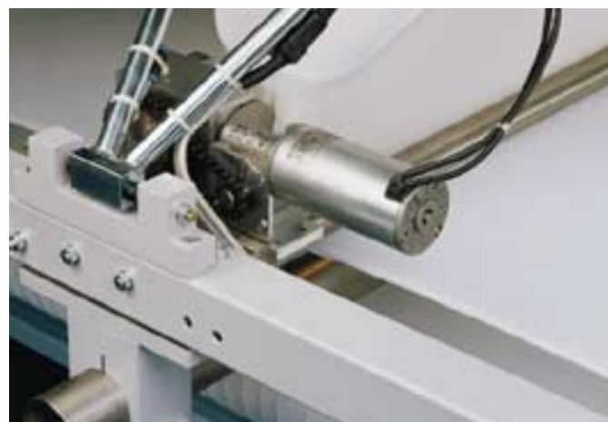
Corte preciso que protege el género, gracias a la cuchilla auto-afilada.
